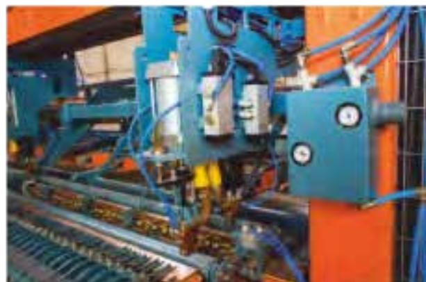
Подвижная сварочная головка с электродом
