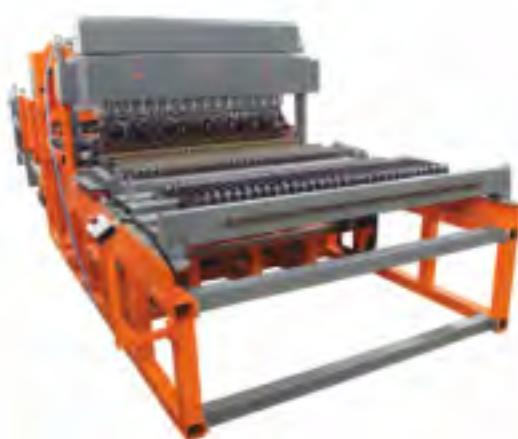
Предназначена для массового производства дорожной и кладочной сетки, ориентирована на крупных производителей. Конструктивные особенности линии соответствуют высоким требованиям к качеству сварки.
