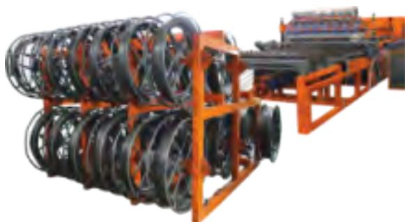
Линия серии WL Компакт предназначена для массового производства кладочной и дорожной сетки, занимает мало места, как и линия серии WP.
