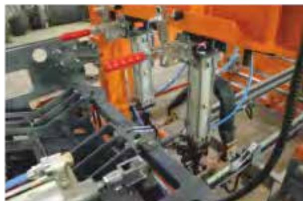
Подвижные цилиндры со сварочными блоками
