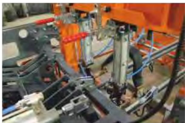
Подвижные цилиндры со сварочными блоками
