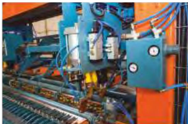
Подвижная сварочная головка с электродом
